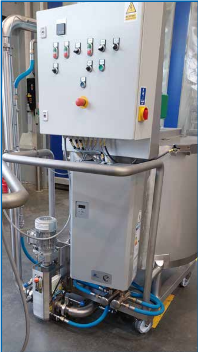
Liquide pompé - garnitures de biscuits, produits de confiserie Pompe - LPX80-1 avec couvercle chauffant, installée verticalement pour gagner de l'espace
