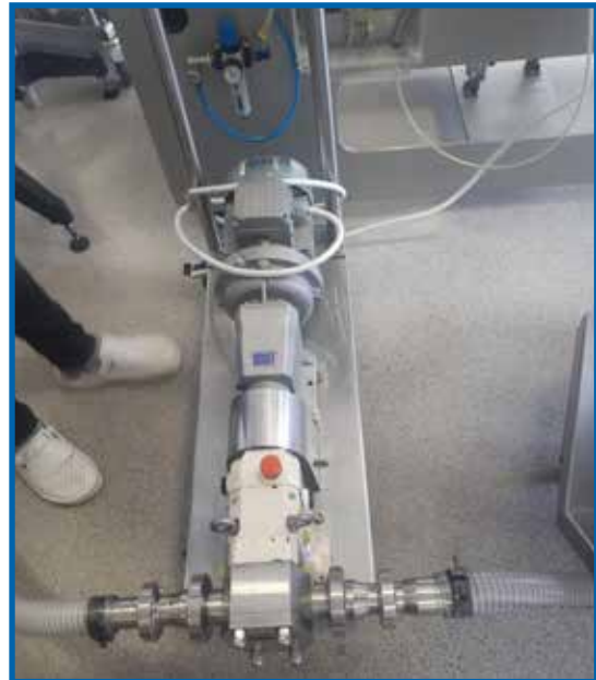
Liquide pompé - dentifrice, gommages corporels, lotions crèmes Pompe - LPX50-1 délivrant 2 m 3 /h à une pression différentielle de 5 bars
