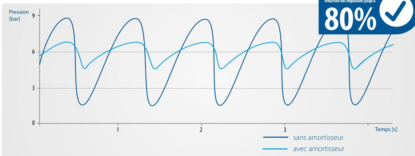
Les amortisseurs de pulsations Tapflo DPT transforment un débit pulsé en un débit plus linéaire. L'amortisseur installé à la sortie de la pompe (bleu clair) diminue les pulsations du flux, comparé à une pompe sans amortisseur (bleu foncé).
